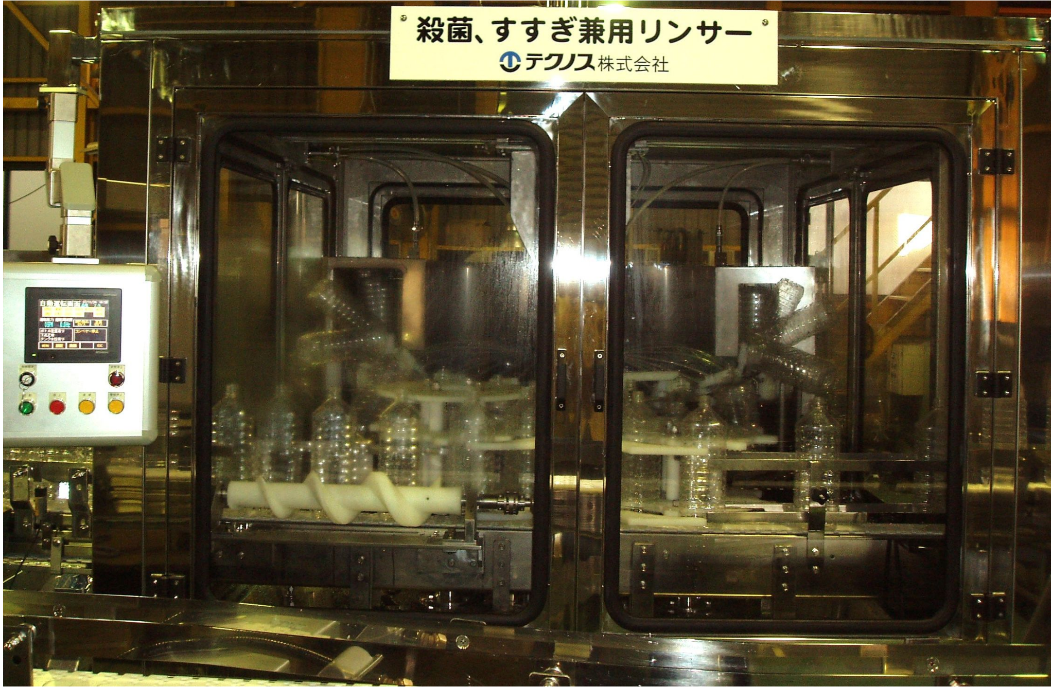
低能力の場合、1台のリンサーで電解水による殺菌と無菌水によるすすぎを行う。
