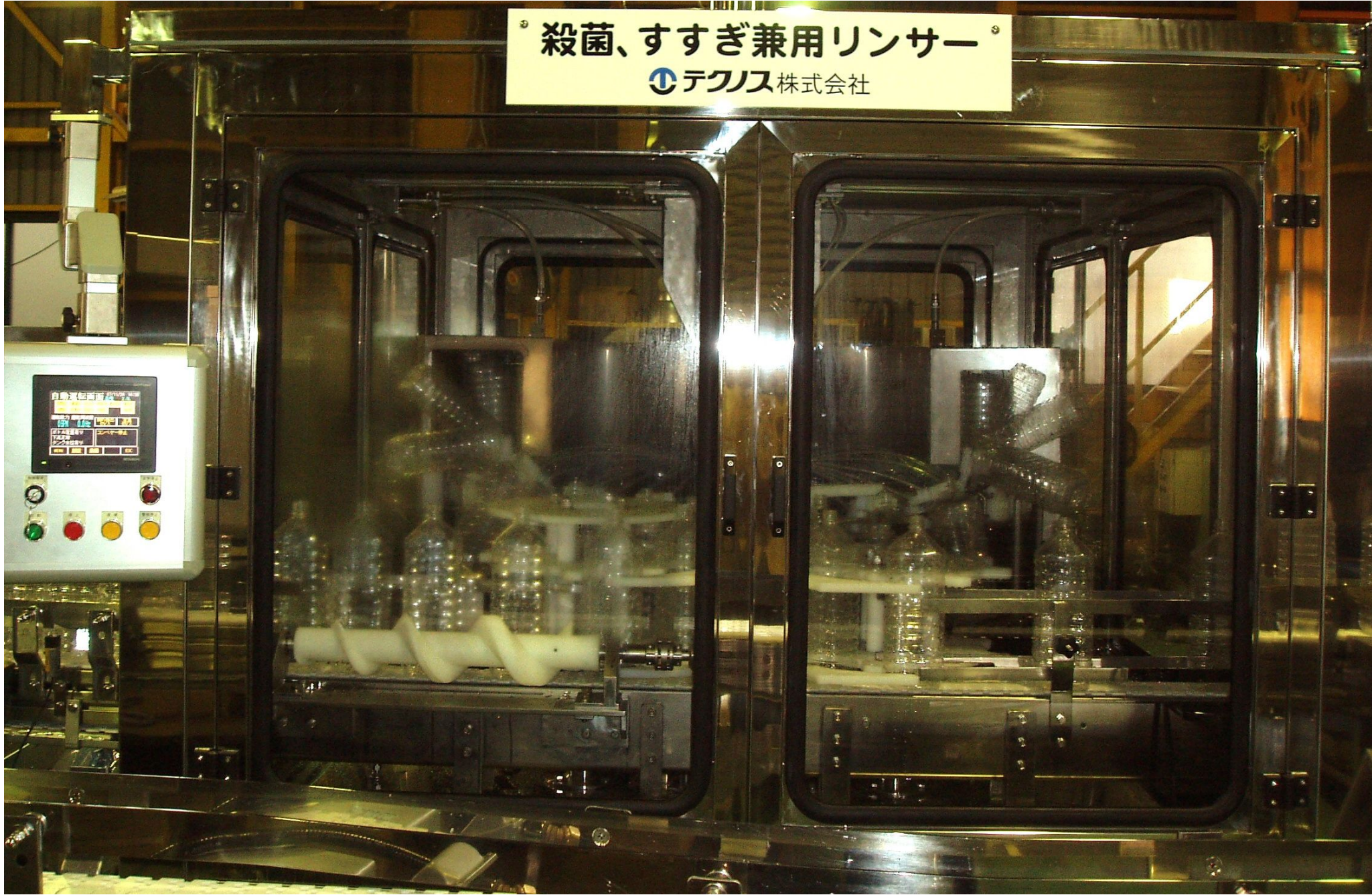
低能力の場合、1台のリンサーで電解水による殺菌と無菌水によるすすぎを行う。
