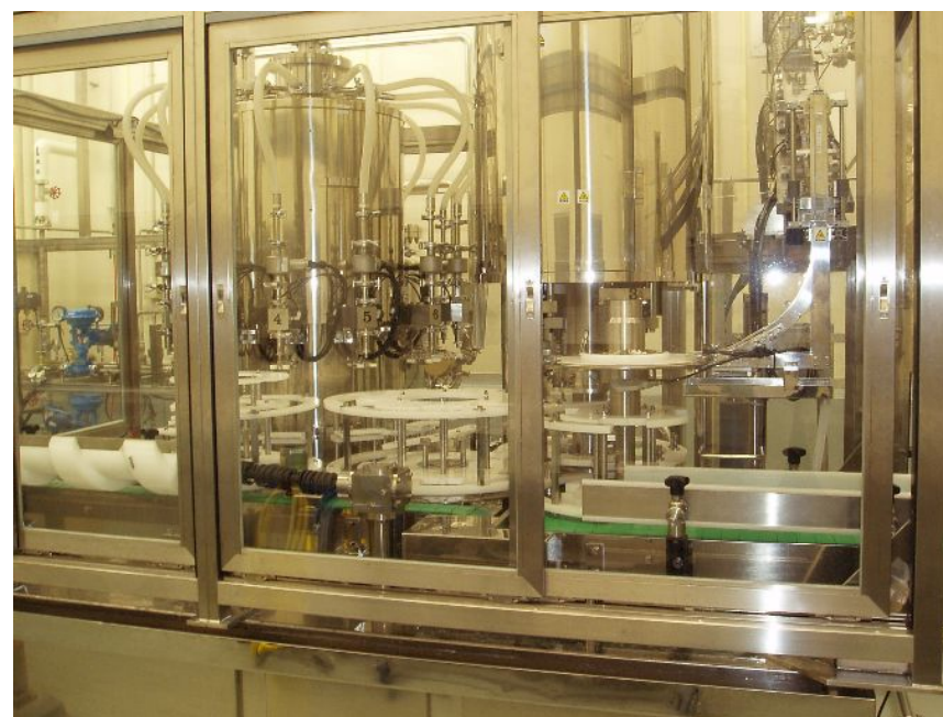
無菌充填機／サーボキャッパー（クリーンブースクラス 100 付）
